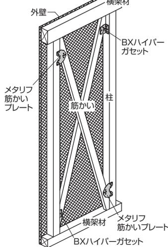
BXハイパーガセット等と併用することで、片側施工でもタスキ筋かいが施工できます。
