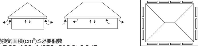
建物幅(m)×100×建物長さ(m)×100×1/250÷有効換気面積(cm<sup>2</sup>)≤必要個数
